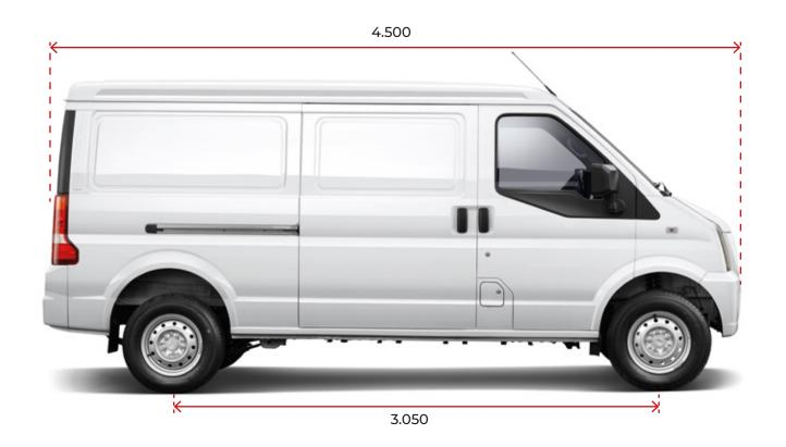
Las dimensiones y el espacio de carga del DFSK EC35 posibilitan muchas aplicaciones distintas. La zona de carga tiene un volumen de 4,8m3 resultando realmente espacioso, además proporciona una carga útil de 1.090kg.
