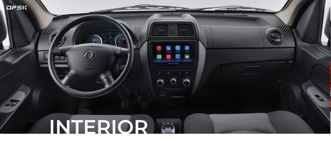
DFSK EC35 viene equipado un tablero de instrumentos digital donde se puede observar el nivel de carga de la batería, lo que le permite anticipar cuándo será necesario volver a enchufar el vehículo.
